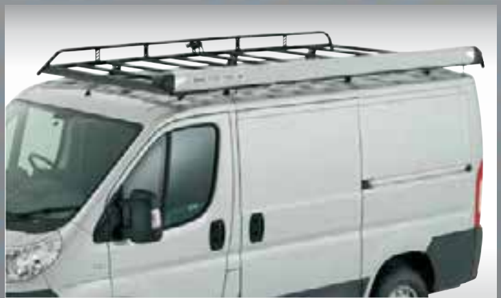
Hergestelt aus pulverbeschichtetem Vierkantrrohr, optional auch in Aluminium lieferbar.
